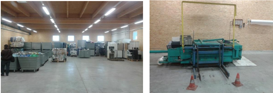
Εικόνα 23: Χώρος αποθήκευσης – συμπίεσης μικρών ανακυκλώσιμων αποβλήτων
