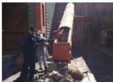
μονάδα μηχανικής κομποστοποίησης
