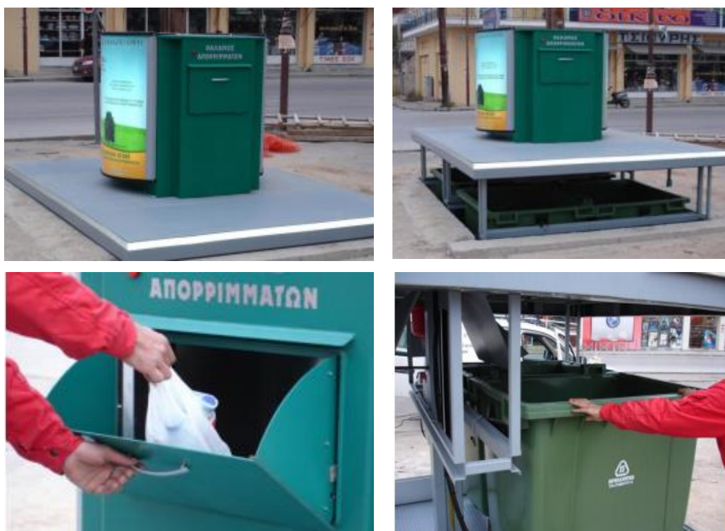
Εικόνα 42: Υπόγειοι κάδοι (ενδεικτικές φωτογραφίες)
