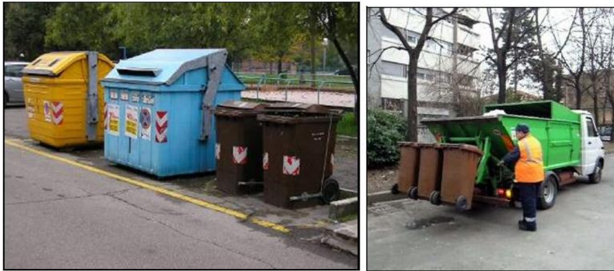
Εικόνα 11: Σύστημα συλλογής σε κεντρικούς κάδους ανά ομάδα κατοικιών και διαδικασία αποκομιδής
