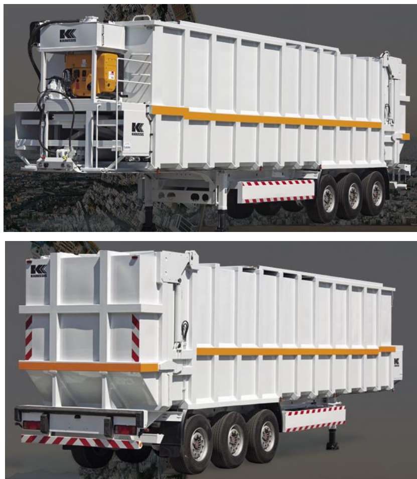
Εικόνα 29: Αυτοσυμπιεζόμενο container χωρητικότητας 56m 3 για τη μεταφόρτωση των απορριμμάτων
