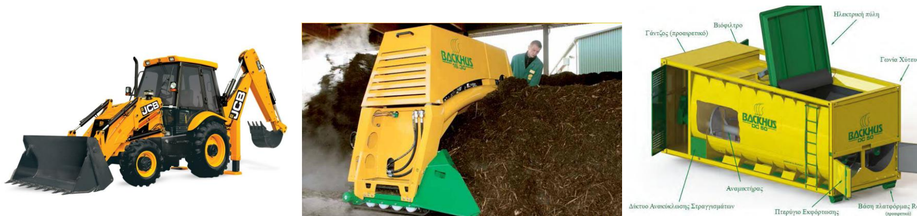
Εικόνα 20. Φορτωτής, Αναστροφέας, Μηχανικός Κομποστοποιητής
