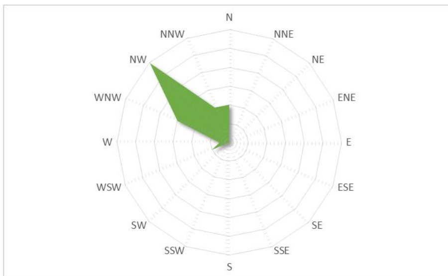
Σχήμα 6.6: Πολικό διάγραμμα κατανομής σχετικών συχνοτήτων διεύθυνσης ανέμου του μετεωρολογικού σταθμού των Άνω Λιοσίων του ΕΕΑ για τον μήνα Νοέμβριο 2017.
