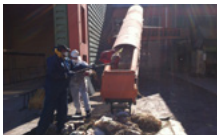
Εισαγωγή του υλικού με χειρωνακτική φόρτωση της μεταφορικής ταινίας που οδηγεί στη μονάδα κομποστοποίησης
