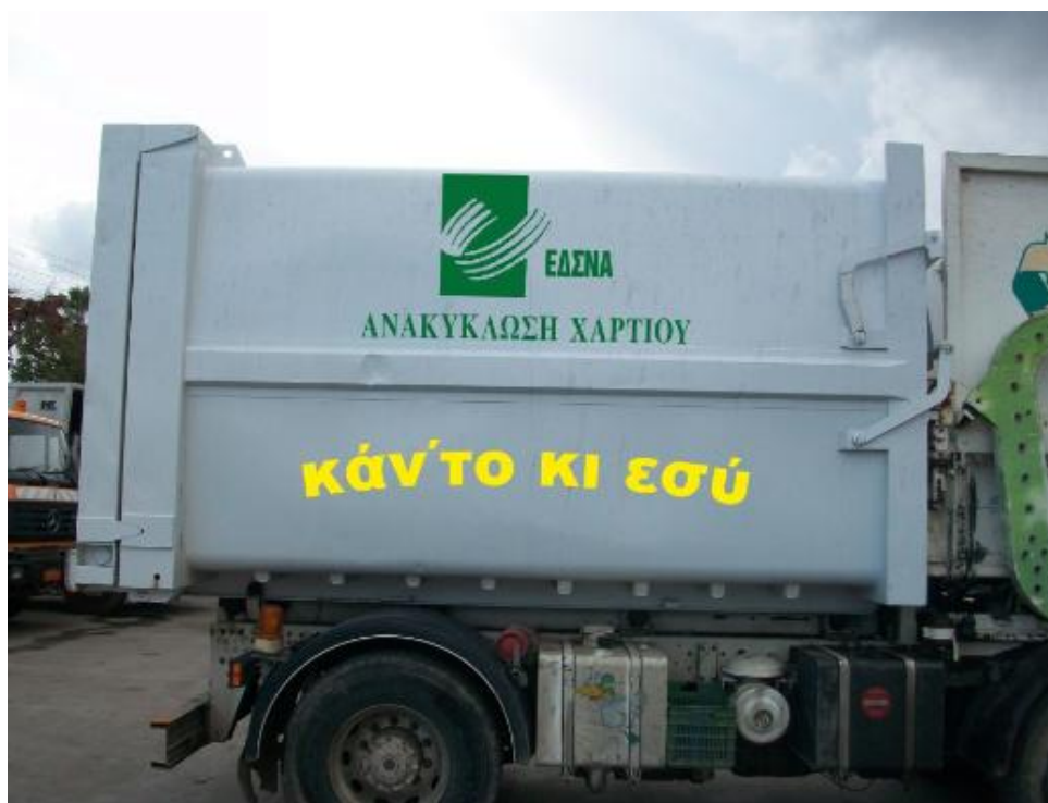
Εικόνα 5:Ειδικού Τύπου απορριμματοφόρου μεταφοράς χαρτιού (packer)
