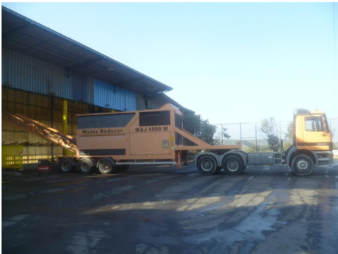
Εικόνα 7: Αυτοκινούμενος λειοτεμαχιστής ογκωδών-πρασίνων
